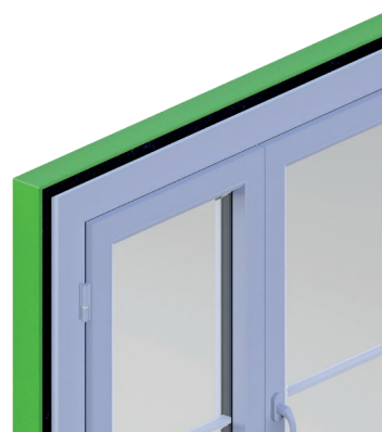
Figure 10 : Jonction angle – Pose en tunnel
