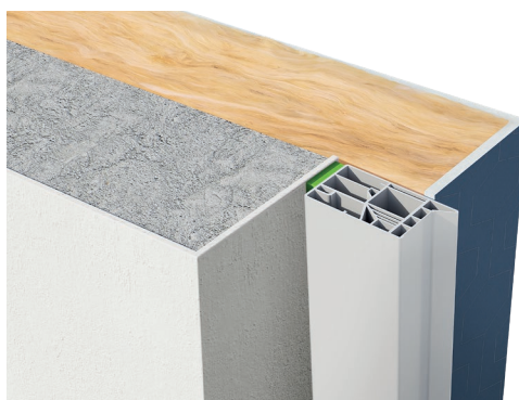
Figure 4 : Tunnel au nu extérieur - ITE sans retour
